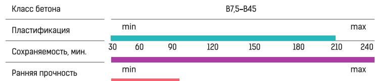
СкайПласт ST 4.3.1 (СТ 4.3.1) – Комплексный суперпластификатор на основе поликарбоксилата для товарных бетонных и растворных смесей. Добавка адаптирована для перекачки водными насосами.
