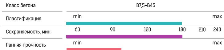
СкайПласт ST 3.0 (СТ 3.0) – Комплексный суперпластификатор на основе поликарбоксилата для товарных бетонных и растворных смесей. Добавка адаптирована для перекачки водными насосами.
